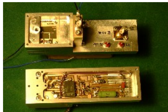
Bild 6: Transverter für 122 GHz
