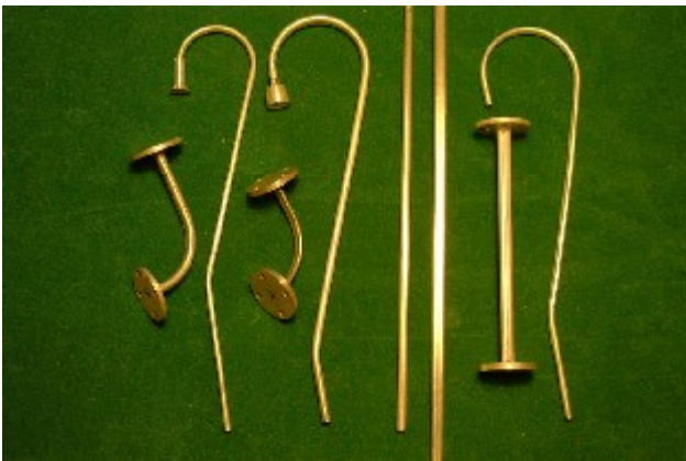
Bild 9: Hohlleiter WR8, WR12, Krückstock
